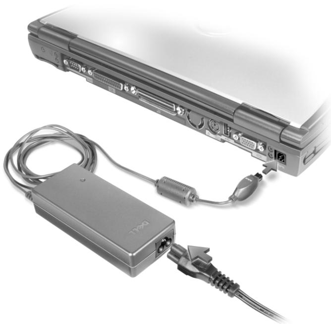
Das Netzteil wandelt Wechselspannung in die vom Computer benötigte Gleichspannung um. Sie können das Netzteil bei ein- oder ausgeschaltetem Computer anschließen.
