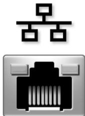
Verbindet den Computer mit einem Netzwerk. Die Leuchtanzeigen neben dem Anschluss zeigen Netzwerkaktivität an (Kabel und kabellos).
